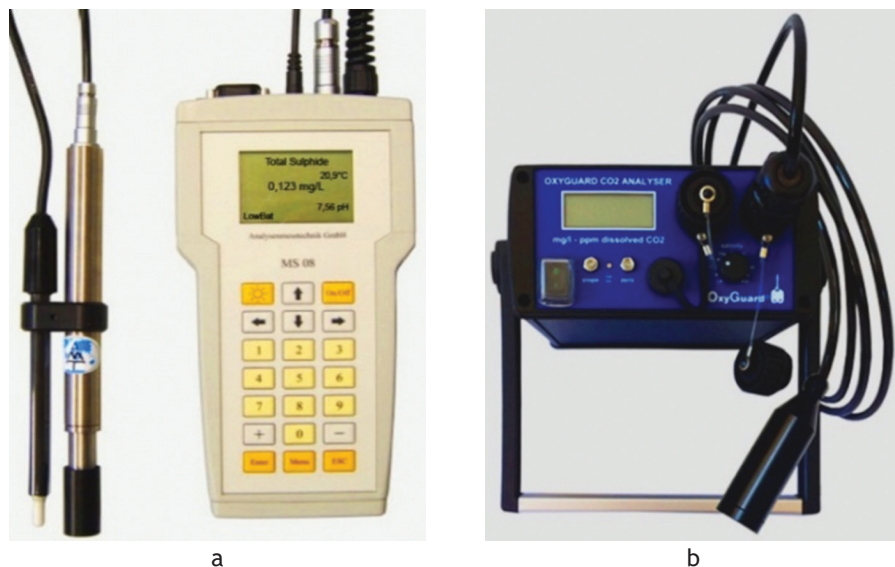
Fig 8. Instrumentul de măsurare cu micro-senzor H_2S și senzor de pH/ temperatură (a), analizor portabil OxyGuard CO_2 într-un set complet (b)
