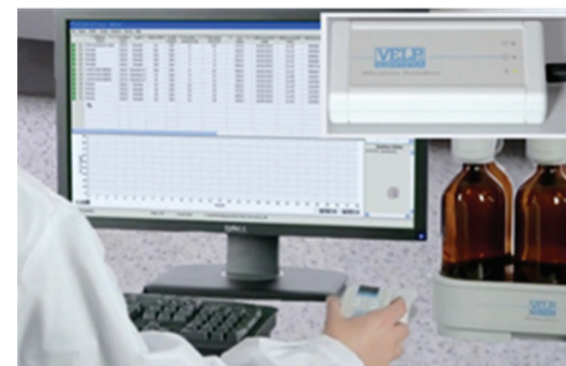
Fig. 10. Transfer de date fără fir de la sistemul senzor BOD EVO 6 la BOD EVO Wireless DataBox cu crearea unei baze de date pentru analiză la PC.
